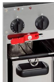
C) Remettez l'huile filtrée dans la cuve ou procéder préalablement au nettoyage de la cuve et du corps de chauffe (voir paragraphe suivant )
